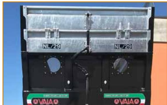
Testata idraulica per s/s 0,80
