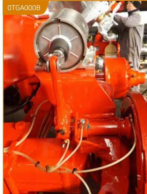
Lubrificazione per assali con pompa elettrica (50 punti) solo per assali e sospensioni idrauliche
