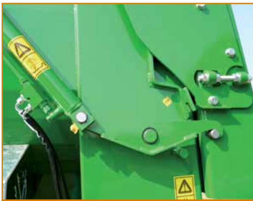
Partic. Porta idr. con gancio meccanico di blocco
